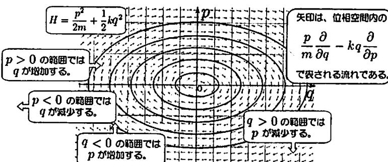
調和振動子の場合の  $-kq \frac{\partial}{\partial p}$  は、 $q > 0$  では  $p$  を下げる方向に、 $q < 0$  では  $p$  を上げる方向に働く演算子となり、結果として位相空間の中で原点の回りを時計回りにぐるぐると回るような運動を作り出す。
