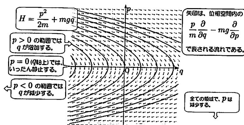
上の図は  $H = \frac{p^2}{2m} + mgq$ 、つまり重力  $mg$  が  $q$  の負方向に働いている状況
